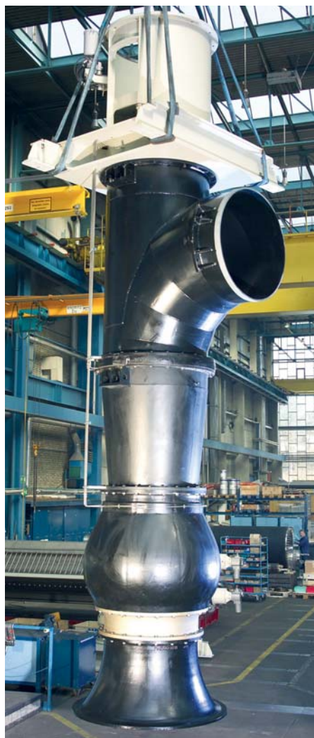
◀ Pompa ad albero verticale per una stazione di pompaggio per irrigazione
