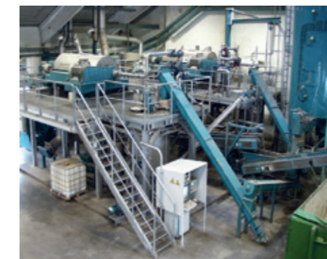
▲ Zweistufige CENSOR-Anlage zum Sortieren von Mischkunststoffen Produkt: reinstes PO-Granulat
